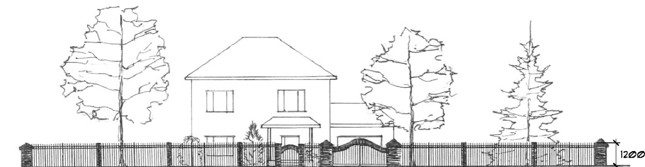
Figure 4 : Clôture en cour avant
